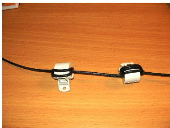
Bild 25 Auch Klappferrite eignen sich sehr gut als Mantelwellensperre
