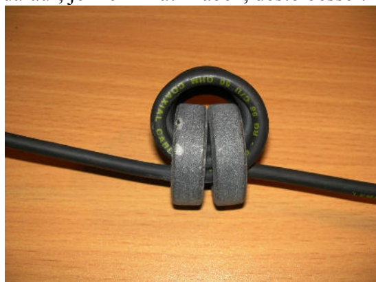
Bild 24 Mantelwellensperre zwischen Fuchskreis und Tranceiver
