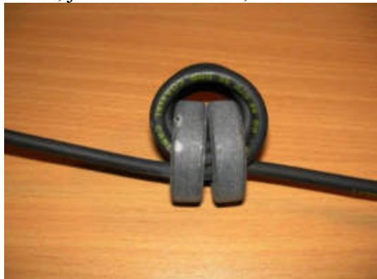
Bild 24 Mantelwellensperre zwischen Fuchskreis und Tranceiver
