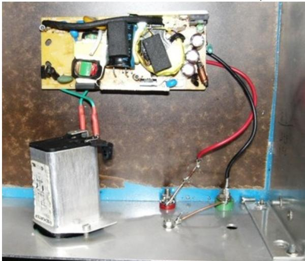
*Bild 29, 5A-Netzteil im Gehäuse eingebaut, vorgeschaltet ein Schurter-Stecker-Filter*
