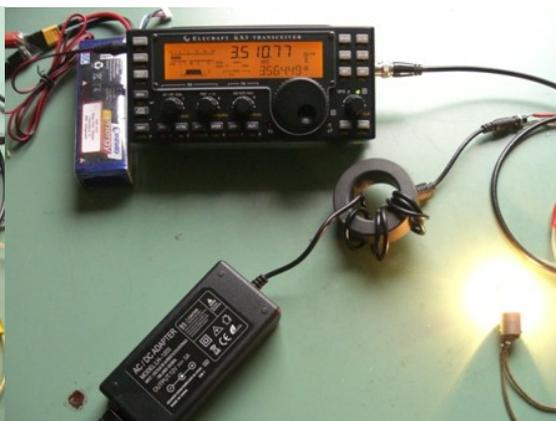
Bild 11, grauer Ferrit-Kern, FT140A-43
