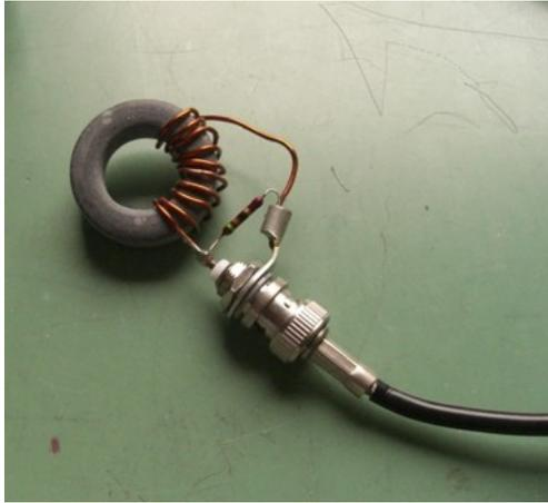
Bild 19, ein selbst gebauter 50Ω-Messkopf
