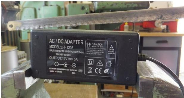
*Bild 22, das aufsägen des verschweissten Gehäuse*
