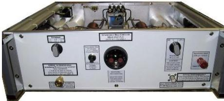
Bild 43 Netznachbildung. (Artificial Mains Network)
