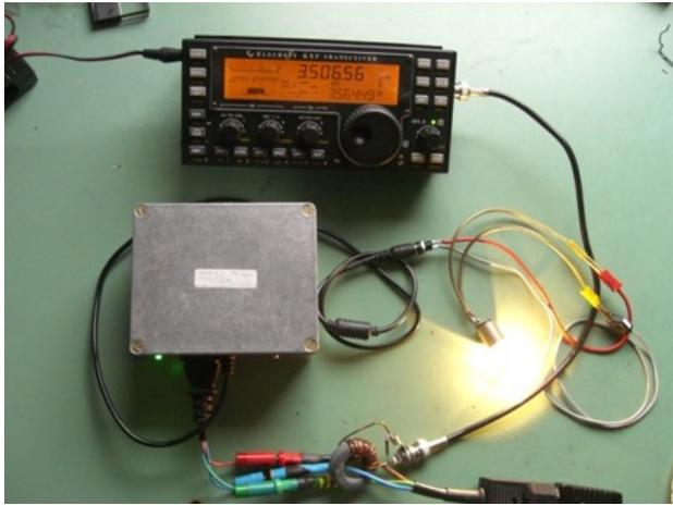
Bild 45, eingebautes Netzteil in einem Metallgehäuse und Schurter-Filter. Resultat, mit dem KX3 sind absolut keine Störungen mehr feststellbar.
