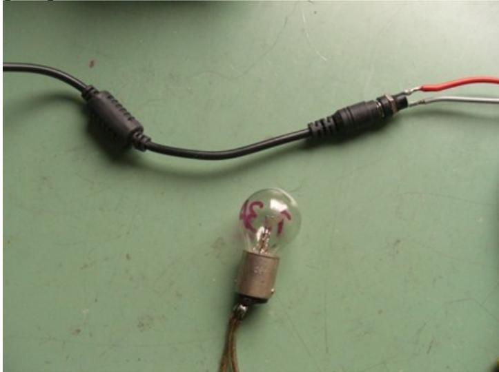
Bild 12, Das Ende des Speisekabels ist mit einer Entstör-Drossel versehen
